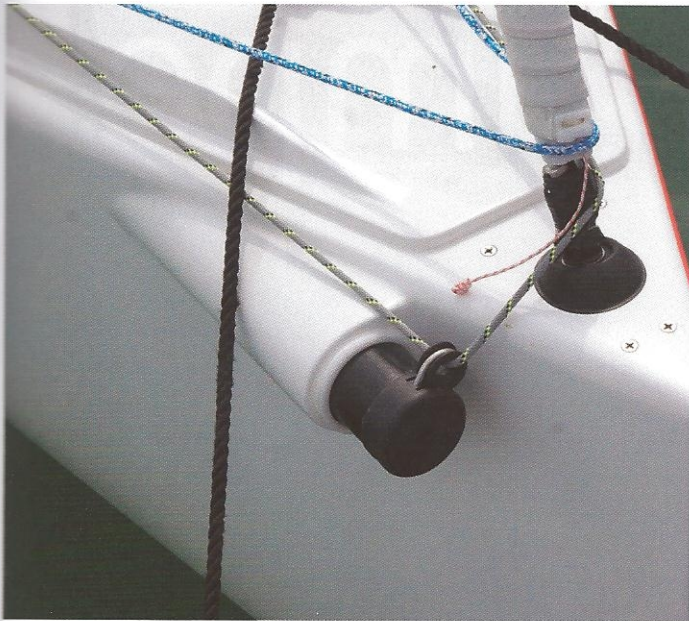
Der Bug mit Fockroller und Gennakerbaum. Gut zu sehen ist das aufgesetzte Deck und die Fußreling.
